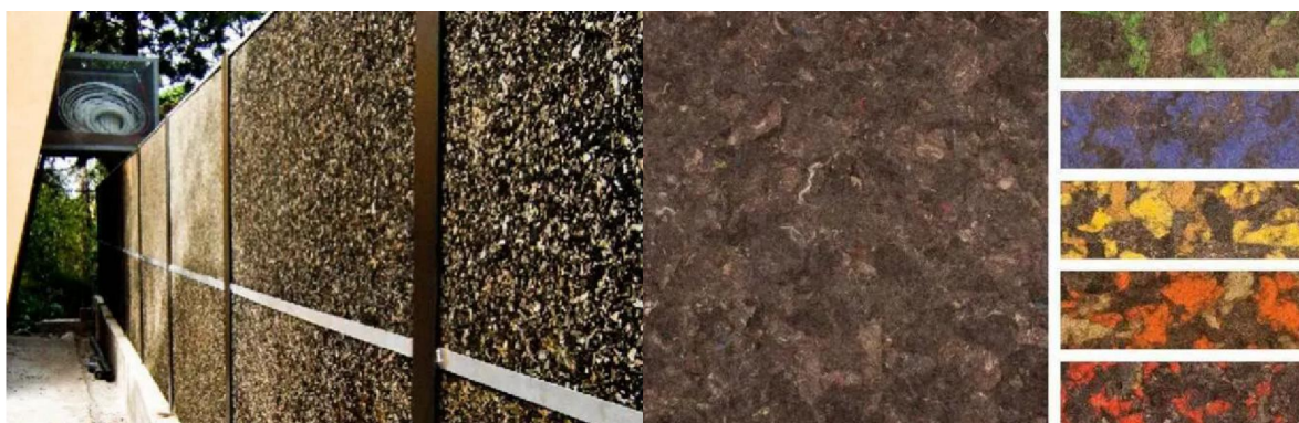
ILUSTRACIÓN 19. MATERIALES DE CONSTRUCCIÓN ELABORADOS A PARTIR DE MOQUETA DEL SECTOR DEL AUTOMÓVIL. PANTALLA ACÚSTICA (IZQUIERDA) Y TABLERO RÍGIDO (DERECHA)
