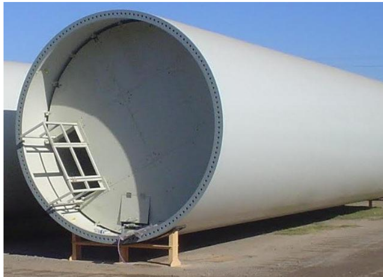
ILUSTRACIÓN 12: TRAMO DE TORRE DE AEROGENERADOR EN EXPLANADA DE FABRICANTE
