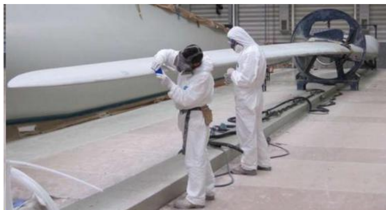
ILUSTRACIÓN 11: ACABADO DE PALA EN FÁBRICA EN AS SOMOZAS
