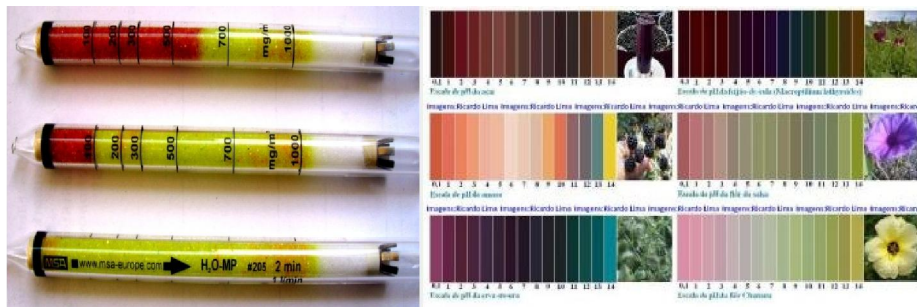
ILUSTRACIÓN7. IZDA. TUBOS COLORÍMETRICOS PARA LA DETECCIÓN DE GASES; DCHA. PATRONES HALOCRÓMICOS PARA MEDICIÓN DE PH
