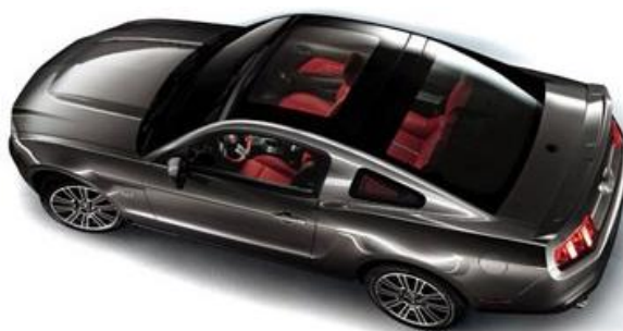
ILUSTRACIÓN5. EJEMPLO DE APLICACIÓN DE VIDRIO ELECTROCRÓMICO
