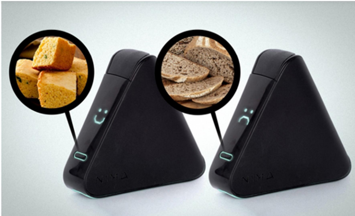
ILUSTRACIÓN 15: NIMA SENSOR, DISPOSITIVO DE SENSORIZACIÓN AVANZADA QUE DETECTA GLUTEN. (FUENTE: https://nimasensor.com/ )
