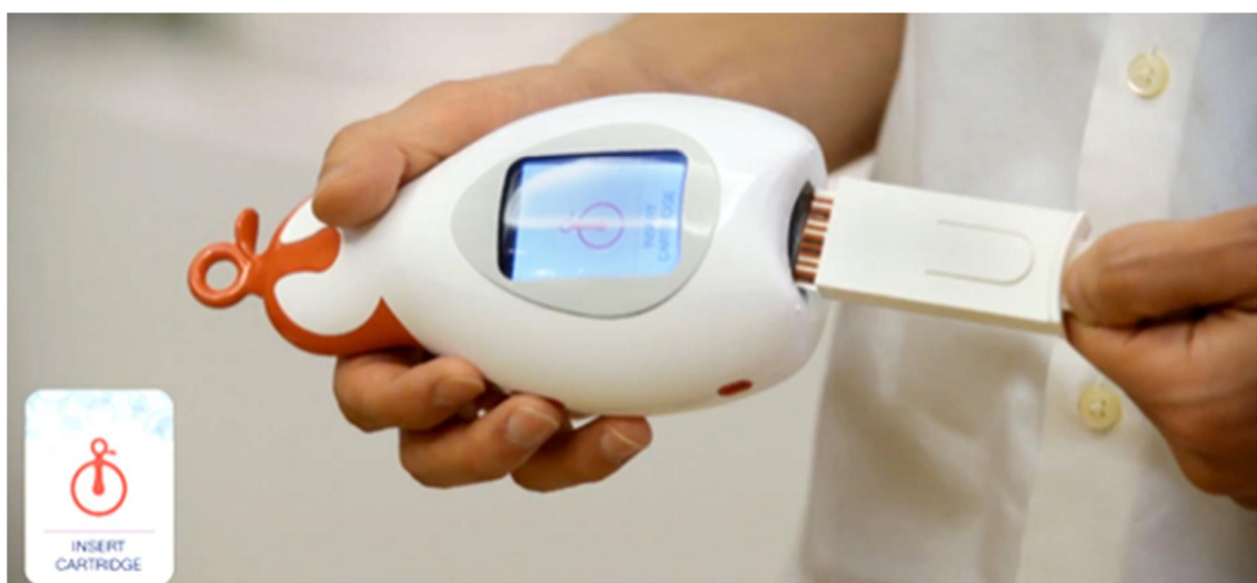
ILUSTRACIÓN 16: PENGUIN, SENSOR AVANZADO QUE DETECTA ANTIBIÓTICOS Y PESTICIDAS. (FUENTE: http://www.penguinsensor.com/en/index.html )
