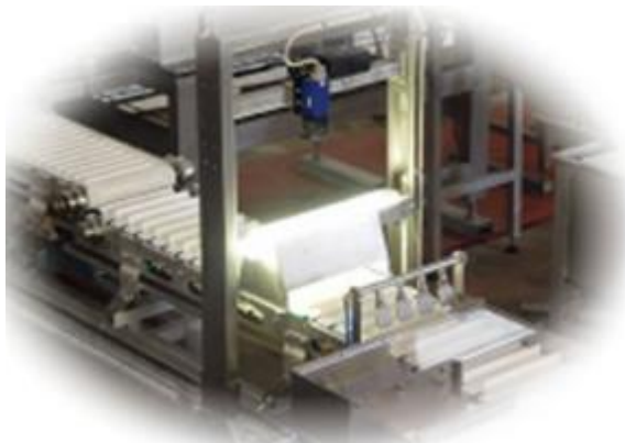
ILUSTRACIÓN 13: EQUIPO DE CLASIFICACIÓN DE PELÁGICOS PARA INDUSTRIA CONSERVERA MEDIANTE VISIÓN ARTIFICIAL (PROYECTO BLUE FISH; https://tacore.es/investigacion-desarrollo/ ).
