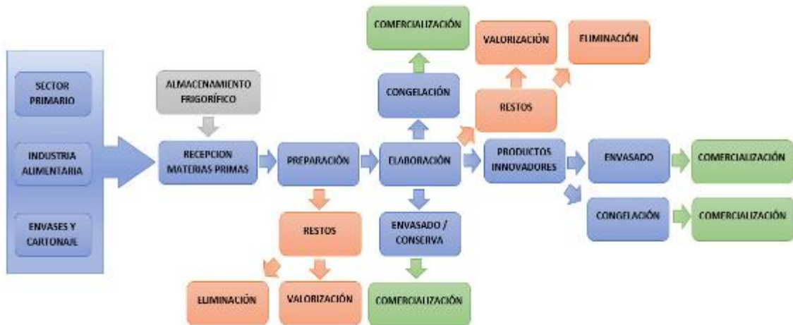
ILUSTRACIÓN 6: DIAGRAMA DE PROCESO DE PRODUCCIÓN GENÉRICO DE LA INDUSTRIA DE ALIMENTACIÓN (FUENTE: ELABORACIÓN PROPIA).
