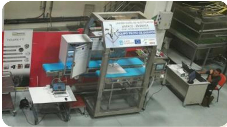
ILUSTRACIÓN 11: EQUIPO DE VISIÓN ARTIFICIAL + ROBOT DELTA EN LA PLANTA PILOTO DE LA UMI ANFACO– EMENASA (FUENTE: PROYECTO FFF4P, http://www.futurefoodfactory.com/ )
